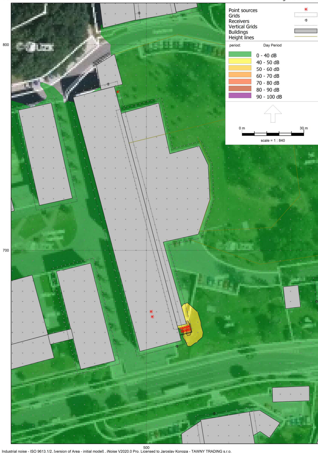
Obr. 4 Situační model s grafickým znázorněním hlukové mapy pro denní a noční dobu ve 3 metrech nad terénem – provoz klimatizačních jednotek
