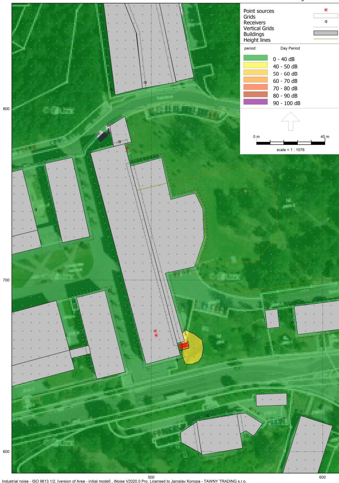
Obr. 5 Situační model s grafickým znázorněním hlukové mapy pro denní a noční dobu v 9 metrech nad terénem – provoz klimatizačních jednotek
